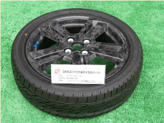
アルミから熱可塑性カーボンに置換、重量40%軽量化16インチホイール プレス1発成形
