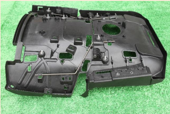
LEXUSLS-500 リヤシート量産採用 試作時 鉄板から複合材料に置換 GMT 重量40%軽量化 コスト20%減 部品点数大幅削減 工程集約
